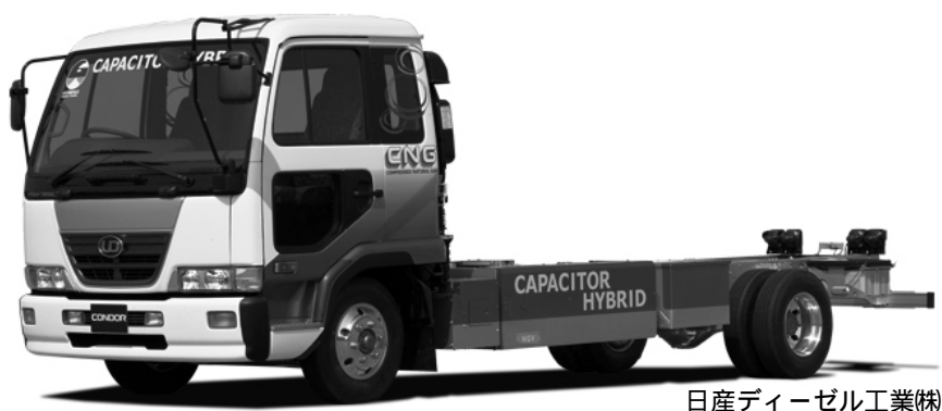
図 16 ECS搭載キャパシタ・ハイブリッドトラック (*)3
