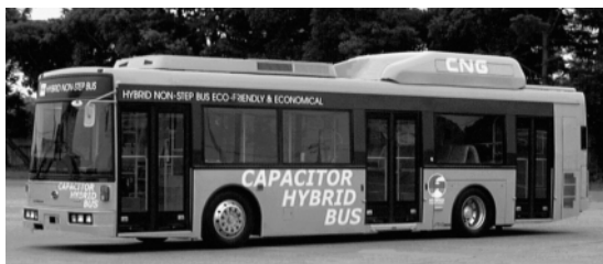
写真2-2 ECSを搭載したキャパシタ・ハイブリッド・バス (3)
