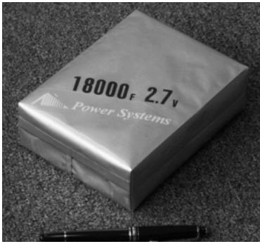
写真3-2 (4) 高エネルギー密度型 ECS 用電気二重層キャパシタ (1ℓ, 単セル) の外観
