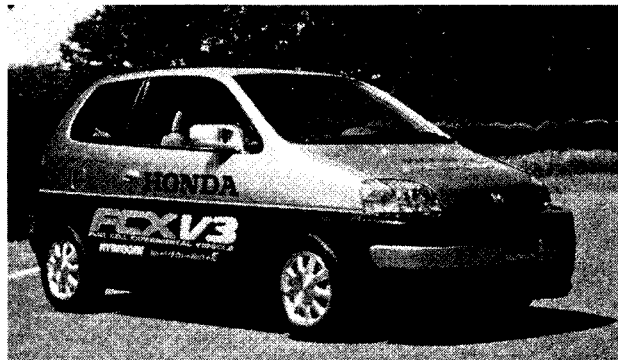
●写真4 キャパシタとのハイブリッドにした燃料電池車 7)
