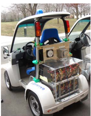
↑後ろ姿。電圧計等が埋め込んであるパネルはステンレス製。さびないからいいだろうと買って来た学生さんは、なかなか加工できなくて苦労していたとか。
