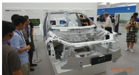
図58 ET7のフレーム構造
