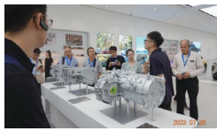
図57 ES8のリア駆動モータ (300kW)
