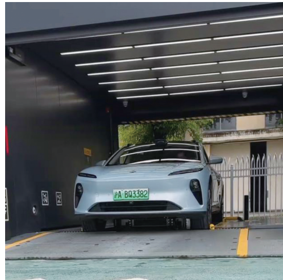
EVの下からバッテリーを装着
