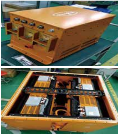
図4. 純電動港湾車両用LICモジュール
