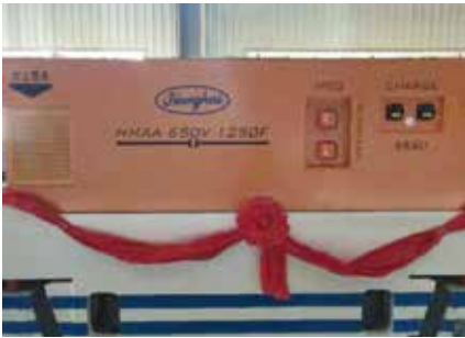
図6. 純電動電気機関車用LICモジュール
