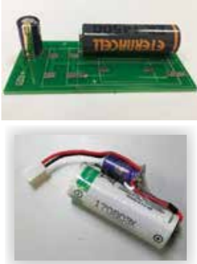
図14. 巻回型LiCと塩化チオニルLi電池との複合独立電源の例
